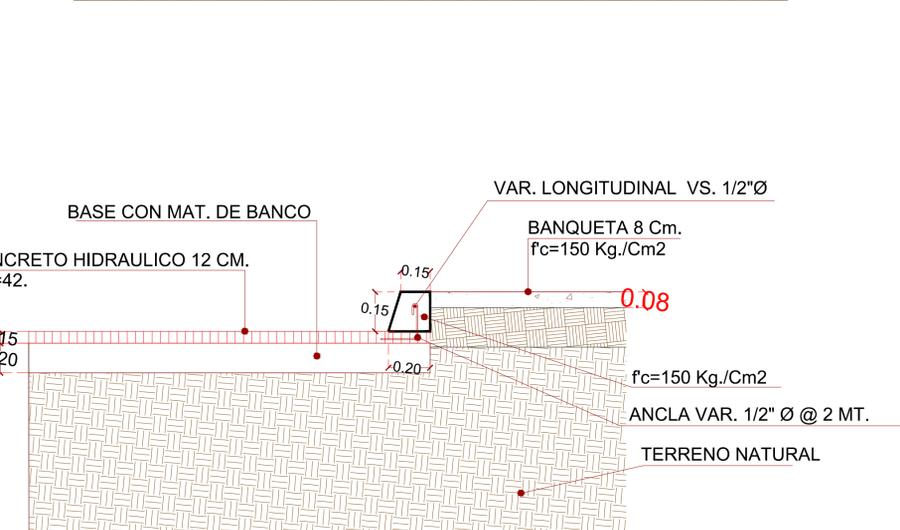
DETALLE DE GUARNICION TRAPESOIDAL
