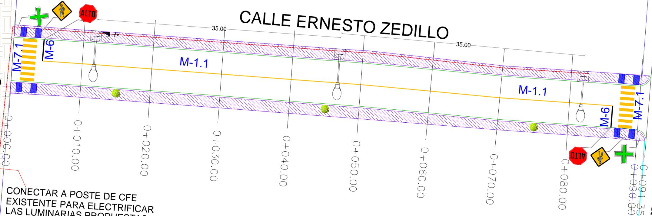
CONECTAR A POSTE DE CFE EXISTENTE PARA ELECTRIFICAR LAS LUMINARIAS PROPUESTAS
